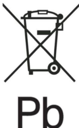
Figure 2 – Exemple de marquage avec le symbole de collecte séparée conformément à l'annexe VI, partie B, et avec le symbole chimique « Pb » pour la teneur en métal lourd Pb conformément aux articles 13.4 et 13.5
