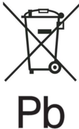
Figuur 2 – Voorbeeld van markering met symbool voor gescheiden inzameling volgens bijlage VI, deel B, en met het chemische symbool "Pb" voor het gehalte aan zware metalen Pb volgens artikelen 13.4 en 13.5 igure 2
