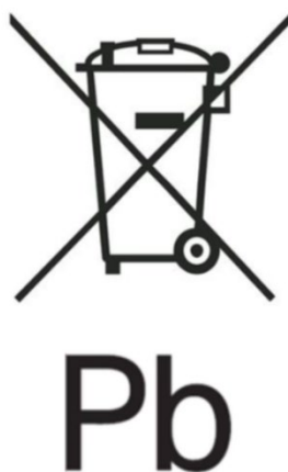
Figur 2 – Eksempel på mærkning med symbol for særskilt indsamling i henhold til bilag VI, del B, og med kemisk symbol "Pb" for indholdet af tungmetaller Pb i henhold til artikel 13.4 og 13.5
