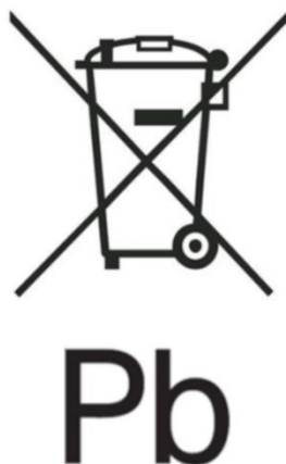
Figura 2 – Exemplo de marcação com símbolo para recolha seletiva, conforme Anexo VI, Parte B, e com o símbolo químico "Pb" para o teor de metal pesado Pb, conforme Artigos 13.4 e 13.5
