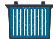
La gasificación controlada mezcla el electrolito y reduce la estratificación
