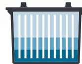
El ácido sulfúrico desciende al fondo de la celda
