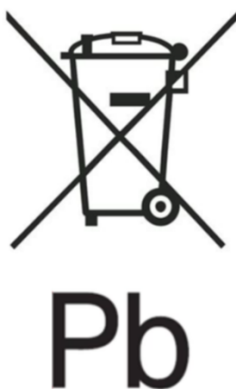
Σχήμα 2 - Παράδειγμα σήμανσης με το σύμβολο για τη χωριστή συλλογή σύμφωνα με το παράρτημα VI μέρος Β και με το χημικό σύμβολο «Pb» για την περιεκτικότητα σε βαρύ μέταλλο Pb σύμφωνα με τα άρθρα 13.4 και 13.5
