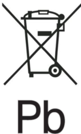
Slika 2. – Primjer označivanja sa simbolom za odvojeno skupljanje prema Prilogu VI. dijelu B i s kemijskim simbolom „Pb” za sadržaj teškog metala olova prema članku 13. stavcima 4. i 5.
