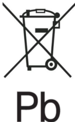
Obrázok 2 – Príklad označenia symbolom pre separovaný zber podľa prílohy VI časti B a chemický symbol „Pb“ pre obsah ťažkého kovu Pb podľa článkov 13 odst. 4 a 13 odst. 5
