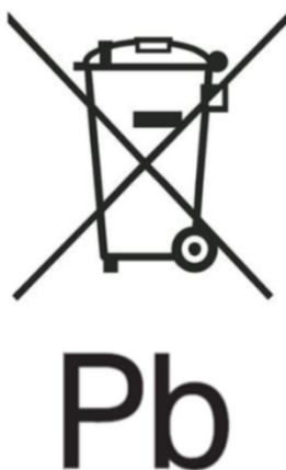
Фигура 2 - Образец за маркировка със символ за разделно събиране съгласно приложение VI, част Б и с химически символ „Pb“ за съдържанието на тежкия метал Pb съгласно членове 13.4 и 13.5
