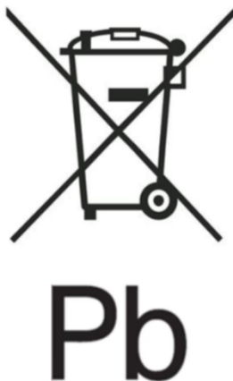
Joonis 2 – Näide märgistusest eraldi kogumise sümboliga vastavalt VI lisa osale B ja keemilise sümboliga „Pb“ seoses plii kui raskemetalli sisaldusega, vastavalt artiklitele 13.4 ja 13.5.
