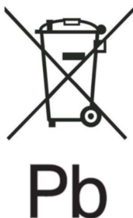
Figure 2 – Exemple de marquage avec le symbole de collecte séparée conformément à l'annexe VI, partie B, et avec le symbole chimique « Pb » pour la teneur en métal lourd Pb conformément aux articles 13.4 et 13.5
