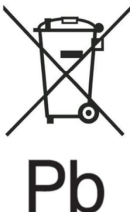
Fíor 2 – Sampla de mharcáil le siombail le haghaidh bailiúcháin ar leithligh de réir larscríbhinn VI Cuid B agus leis an tsiombail cheimiceach "Pb" don chion miotail throm Pb de réir Airteagail 13.4 agus 13.5
