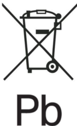
2. attēls. Marķējuma piemērs: dalītas savākšanas marķēšanas simbols saskaņā ar VI pielikuma B daļu un ķīmiskā elementa "Pb" marķēšanas simbols, kas norāda smagā metāla Pb saturu, saskaņā ar 13.4. un 13.5. pantu
