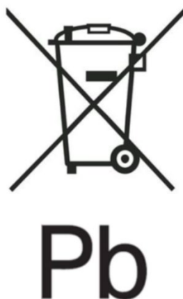
Figuur 2 – Voorbeeld van markering met symbool voor aparte verzameling volgens Bijlage VI Deel B en met de chemisch symbool "Pb" voor het zware metaalgehalte Pb volgens artikelen 13.4 & 13.5
