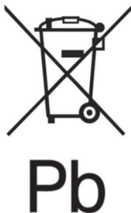
Schemat 2 – Przykład oznaczenia symbolem selektywnej zbiórki wg Załącznika VI Część B i chemiczny symbol pierwiastka "Pb" do zawartości metali ciężkich jak w Artykułach 13.4 i 13.5
