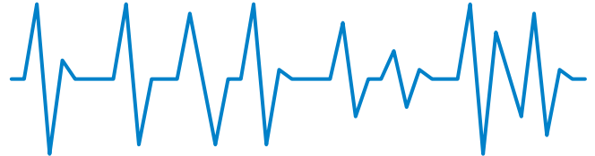
Typowy wzór stanu naładowania podczas jazdy pojazdem z systemem Start-Stop.
