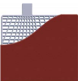
Płyta dodatnia pokryta dwutlenkiem ołowiu ( PbO_2 )
