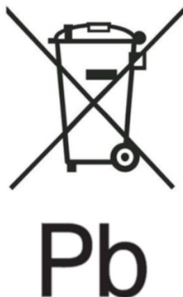
Figur 2 – Exempel på märkning med symbol för separat insamling i enlighet med del B i bilaga VI och med kemisk beteckning "Pb" för tungmetallhalten Pb enligt artiklarna 13.4 och 13.5
