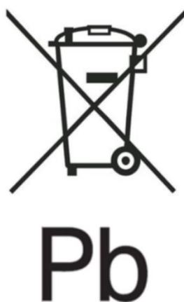
Figuur 2 – Voorbeeld van markering met symbool voor gescheiden inzameling volgens bijlage VI, deel B, en met het chemische symbool "Pb" voor het gehalte aan zware metalen Pb volgens artikelen 13.4 en 13.5
