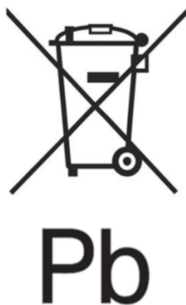
Figura 2 – Exemplu de marcă cu simbol pentru colectarea separată în conformitate cu anexa VI, partea B și cu simbolul chimic „Pb” pentru conținutul de Pb din metale grele în conformitate cu articolele 13.4 și 13.5
