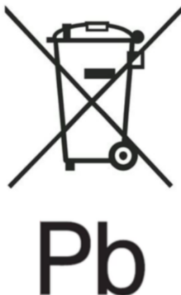
Slika 2 – primer označevanja s simbolom za ločeno zbiranje v skladu s Prilogo VI, del B in s kemijskim simbolom »Pb« za vsebnost težke kovine Pb v skladu s členoma 13.4 in 13.5
